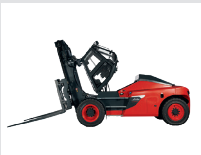
Der Motorzugang erfolgt durch die kippbare Kabine
