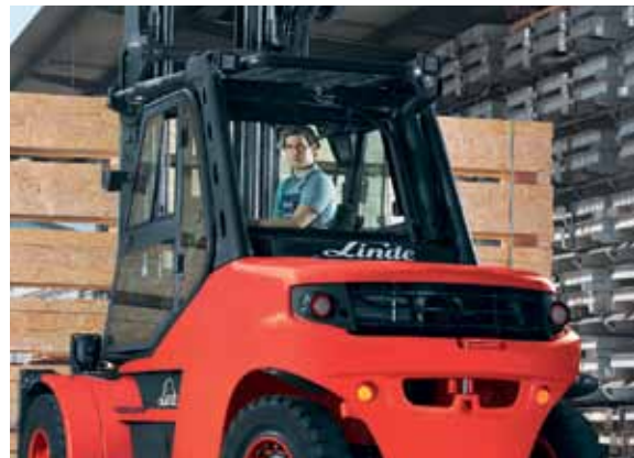
Drehbarer Fahrerarbeitsplatz mit komplett schwenkbaren Pedalen und Bedienelementen. Ob Vorwärts- oder Rückwärtsfahrt – mit einer leichten Kopfbewegung hat der Fahrer Last und Fahrstrecke im Blick.
