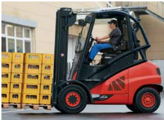
Linde Stapler in der Getränkeversion. Aus der erhöhten Kabine hat der Fahrer stets guten Überblick – auch bei hoch gestapelten Lasten auf der Gabel.
