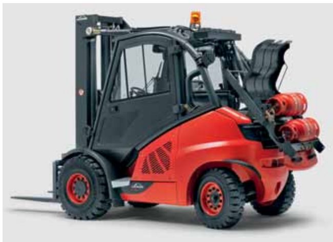
Ergonomischer Flaschenwechsel im Treibgasbetrieb. Ohne unnötigen Kräfteinsatz des Fahrers.
